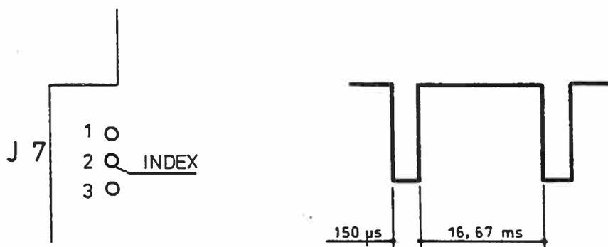
Falls dieses Signal nicht gemessen werden kann, so ist wahrscheinlich der Indexsensor selbst defekt. Dieser kann ausgetauscht werden.
